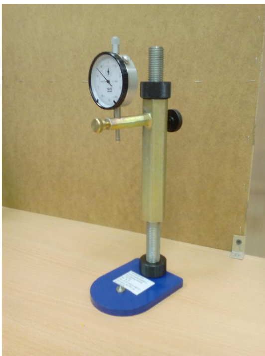
Устройство для определения усадки и расширения бетона «УБ-40»
