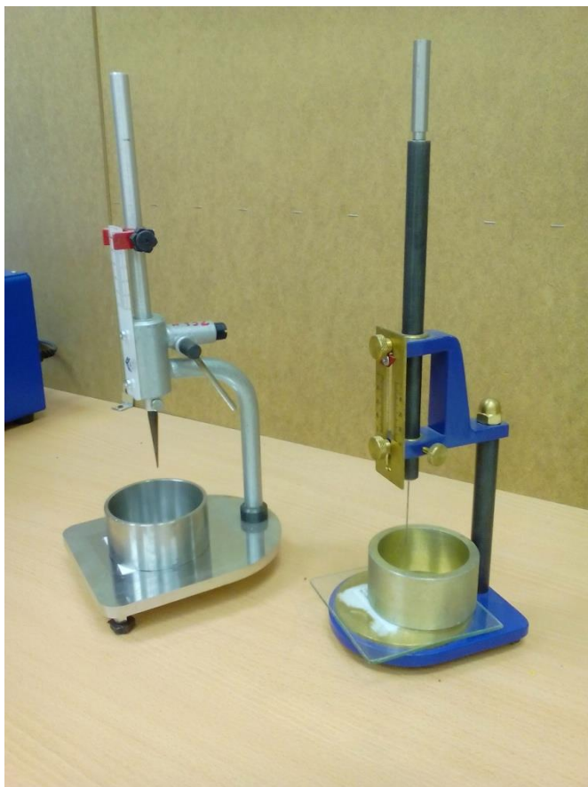
Устройство для определения усадки и расширения бетона «УБ-40»
